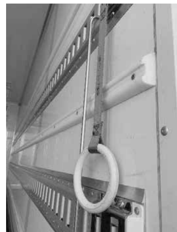
写真3 サポートハンドルの取付
